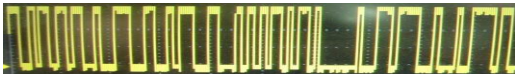
示波器检测 GPIO2 管脚图形
